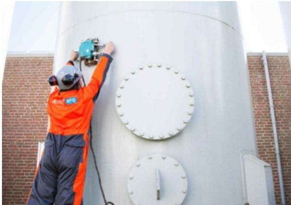
Applus+ ha desarrollado un enfoque sistemático para los ensayos por fugas de flujo magnético, de manera que las inspecciones se realizan con tecnología de vanguardia y la información obtenida se presenta con el nivel de detalle necesario para evaluar si el depósito es adecuado para seguir funcionando.
